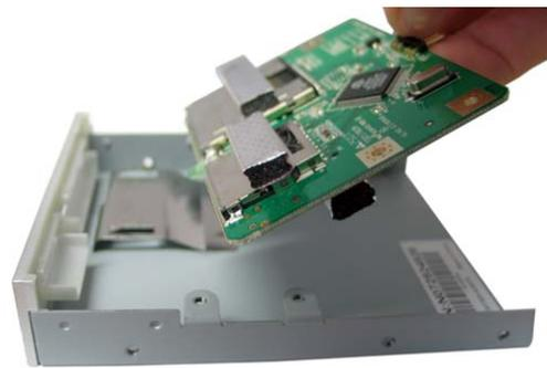
4 Entfernen Sie die Platine
