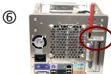
⑥ Schrauben Sie die Steckplatz-Abdeckung wieder fest.
