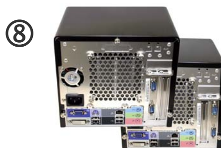
⑧ Das Slotblech belegt wahlweise den PCI-Steckplatz oder den PCI-Express-x16-Steckplatz.
