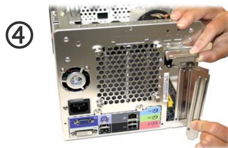
④ Heben Sie den Bügel hoch und entfernen Sie eins der beiden Slotbleche.
